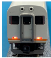
後進時点灯状態 ヘッドライト消灯 テールライト点灯
